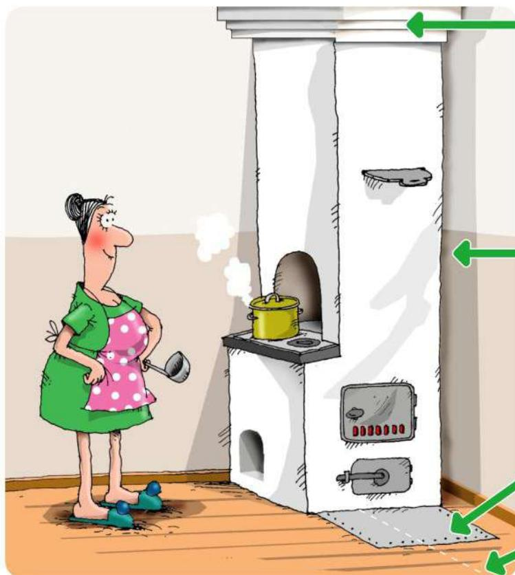
Разделка – утолщение в кладке печи и дымохода, создающее малотеплопроводимый слой между нагретой частью печи и легковоспламеняющимися элементами, препятствующее загоранию конструкций, прилегающих к печи.
